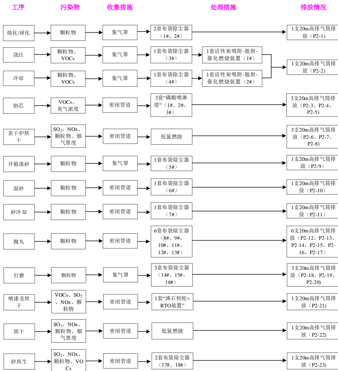
图 8.1-1 废气收集净化措施流程图
